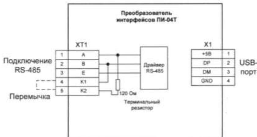
Рисунок 2 – Схема внешних подключений
